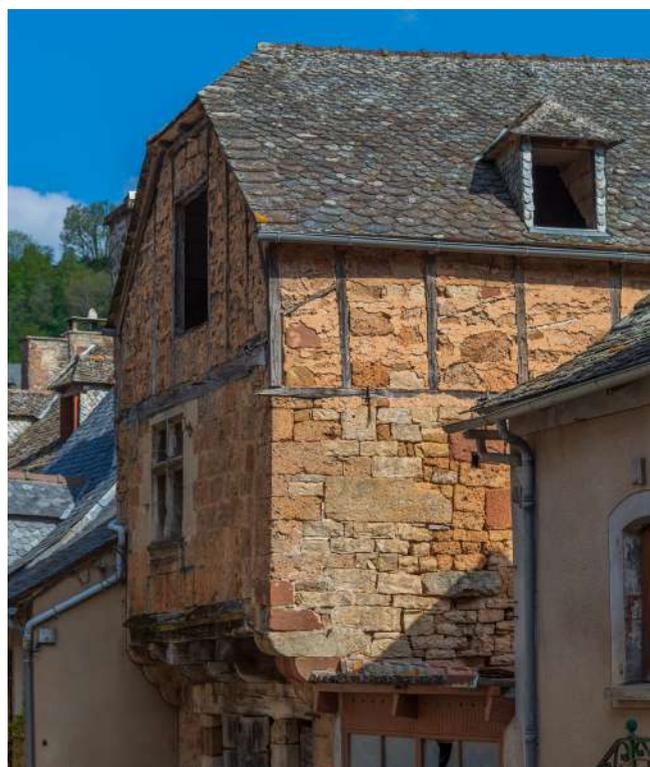
Ce sont des bâtiments construits essentiellement entre le XVe et le XVIIIe siècle. Leur structure porteuse est composée d'un assemblage de pièces de bois formant la façade de la maison et appuyée contre des murs de pierre. Elle supporte les charges et ne sont pas décoratives. Les vides entre poutres et poteaux sont comblés par un remplissage de type torchis, briquette, protégés par un enduit recouvert d'un badigeon à la chaux.
