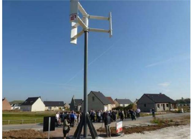
Figure 47 : Éolienne à axe vertical installée sur l'écoquartier La Marlière à Courcelles-lès-Lens
